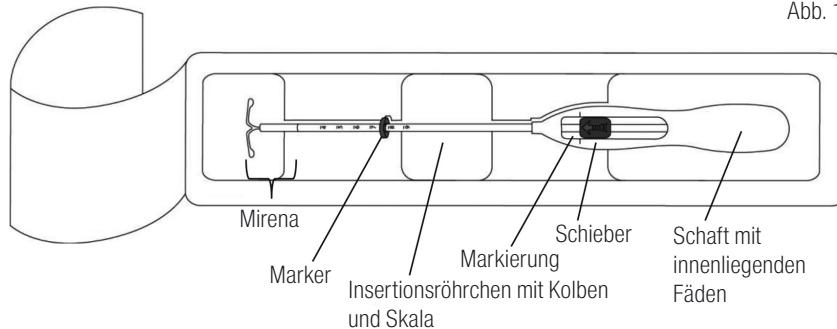
2. Drücken Sie den Schieber in Pfeilrichtung bis zur äußersten Position **nach vorne**, um Mirena in das Insertionsröhren zu laden (Abb. 2).
