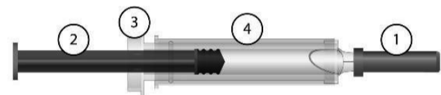
Bild 3: Spritze mit manuellem Sicherheitssystem mit NACH GEBRAUCH über die Nadel gezogenem Sicherheitszylinder
