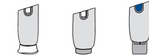
Vor der Anwendung (mit weißer Schutzkappe) Vor der Anwendung (ohne weiße Schutzkappe) Nach der Anwendung (Nadelschutzhülle ausgefahren)
