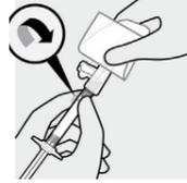
Die Spritze mit der Spritzenspitze nach oben halten. Befestigen Sie die Sicherheitskanüle mit einer leichten Drehbewegung an der Spritze, um ein Brechen oder eine Beschädigung der Farbcodierung am Kanülenansatz zu vermeiden. Prüfen Sie vor der Anwendung immer auf Anzeichen einer Beschädigung oder Undichtigkeit.
